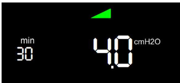
На дисплее отображается оставшееся время и текущее давление в режиме плавного пуска.
