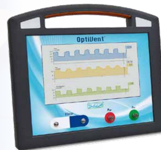
PESO-Monitor als Alternative zur beatmungsgeräteseitigen Oesophagusdruckmessung
