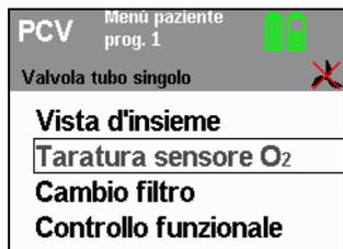
1. Verificare che il sensore dell'ossigeno sia collegato.
