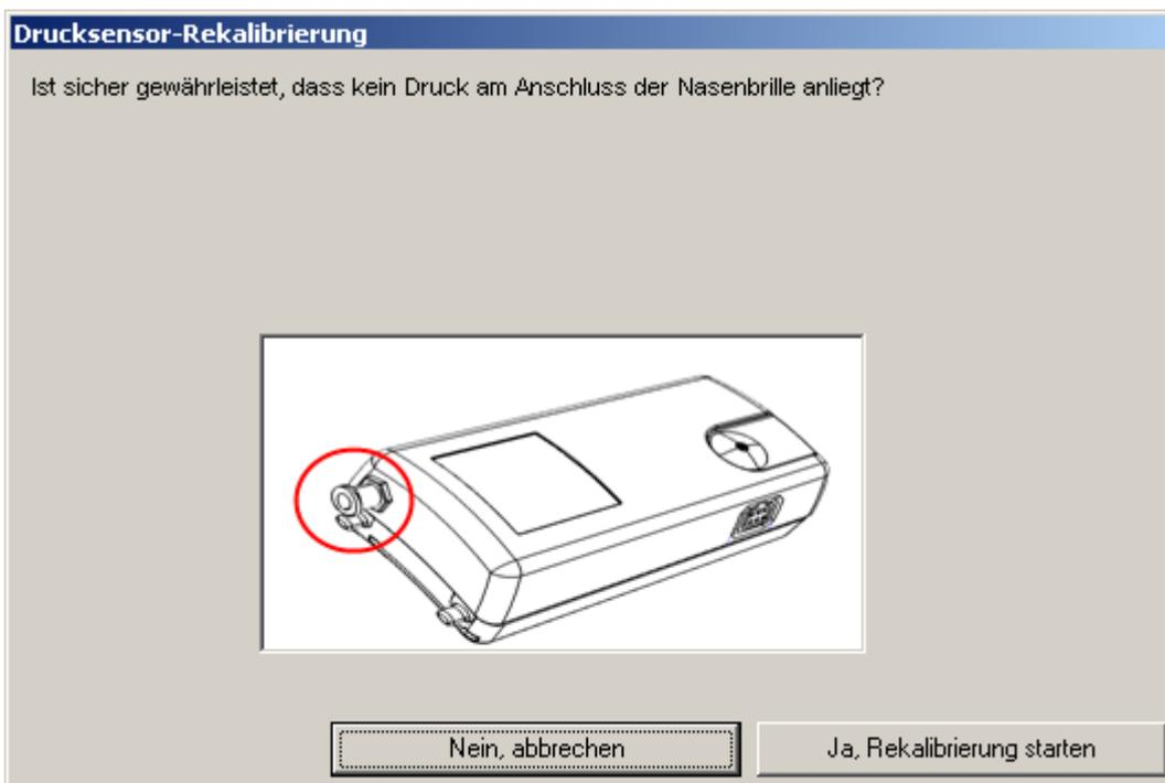
7. Wenn kein Druck am Anschluss der Nasenbrille anliegt: **Ja, Rekalibrierung starten** klicken. Der Drucksensor wird recalibriert. Dieser Vorgang kann bis zu 30 Sekunden dauern.
